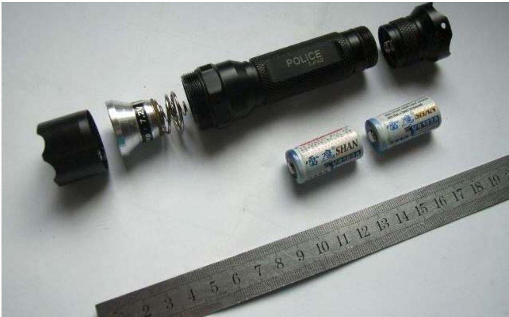
图 4 手电筒结构示意图
